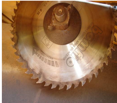
Retiro de la sierra circular defectuosa y paralización de la actividad.
