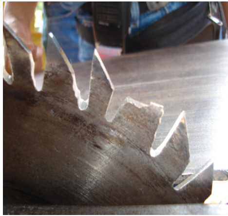
Sierra circular en condiciones inadecuadas para emplearlas.
