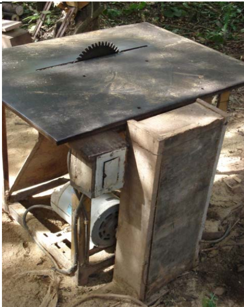
Sierra circular en condiciones inadecuadas para emplearlas.
